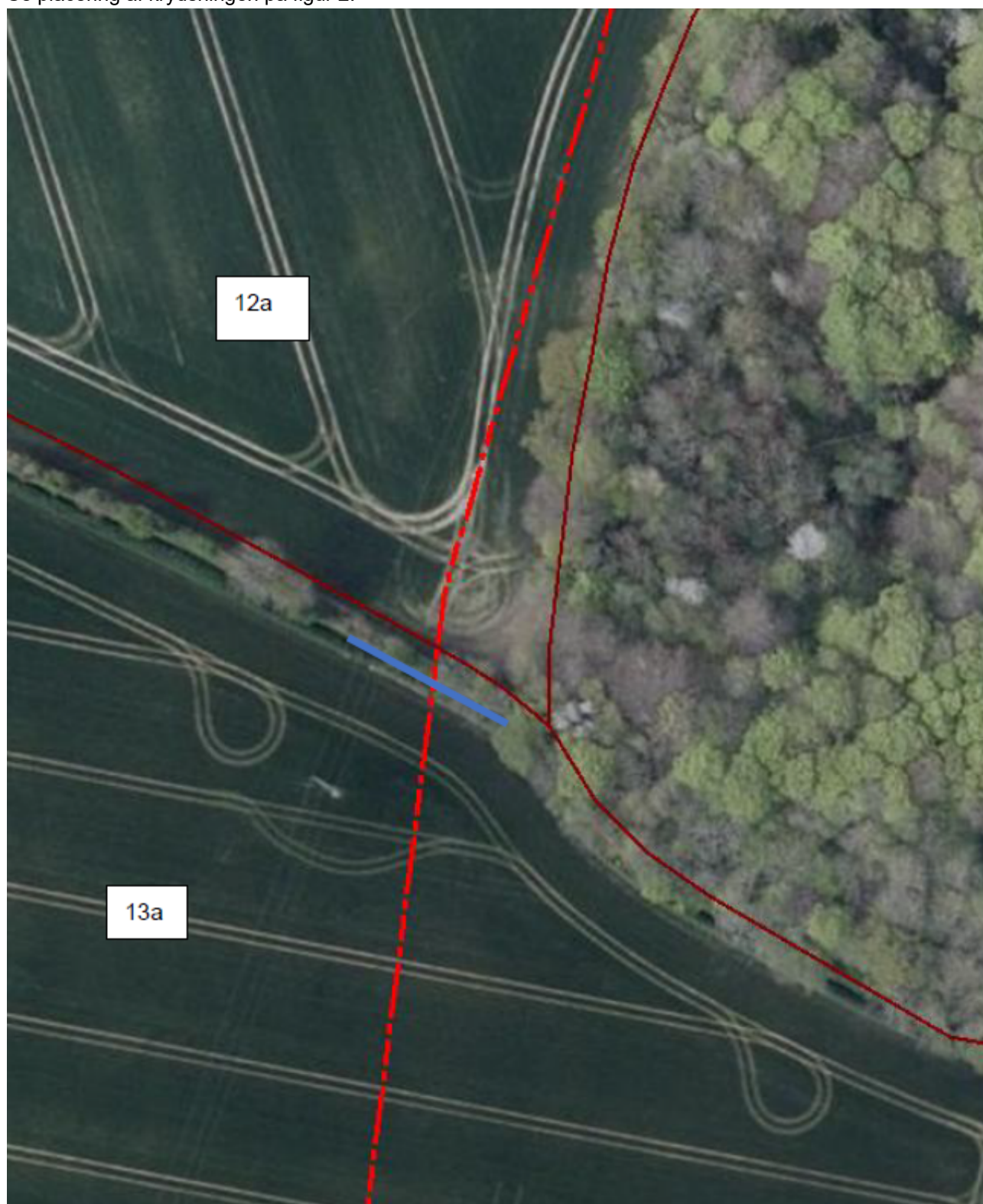
Figur 2: Kort fremsendt af ansøger, Langelands Forsyning A/S. Nærmeste adresse: Lindegårdsvej 4, 5900 Rudkøbing. Rød stiplede streg er forløb transmissionledning der med projektet vil krydse det private vandløb. Blå streg indikerer forløb af vandløb. Matrikelnummer fremgår i hvide tekstbokse.
