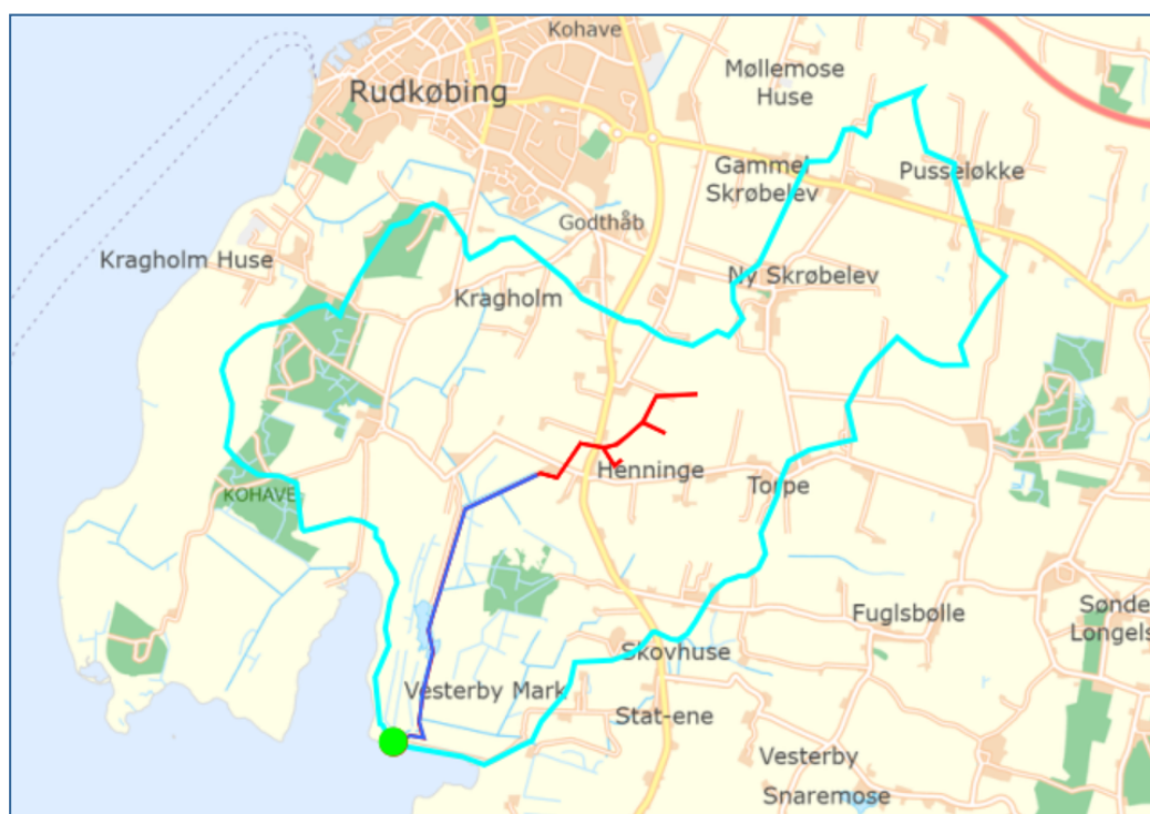
Figur 3. Rørlagt (rød) og åben (blå) strækning af vandløbet Henninge-afløbet med dets oplandsgrænse (turkis) og pumpe ved kysten (grøn).
