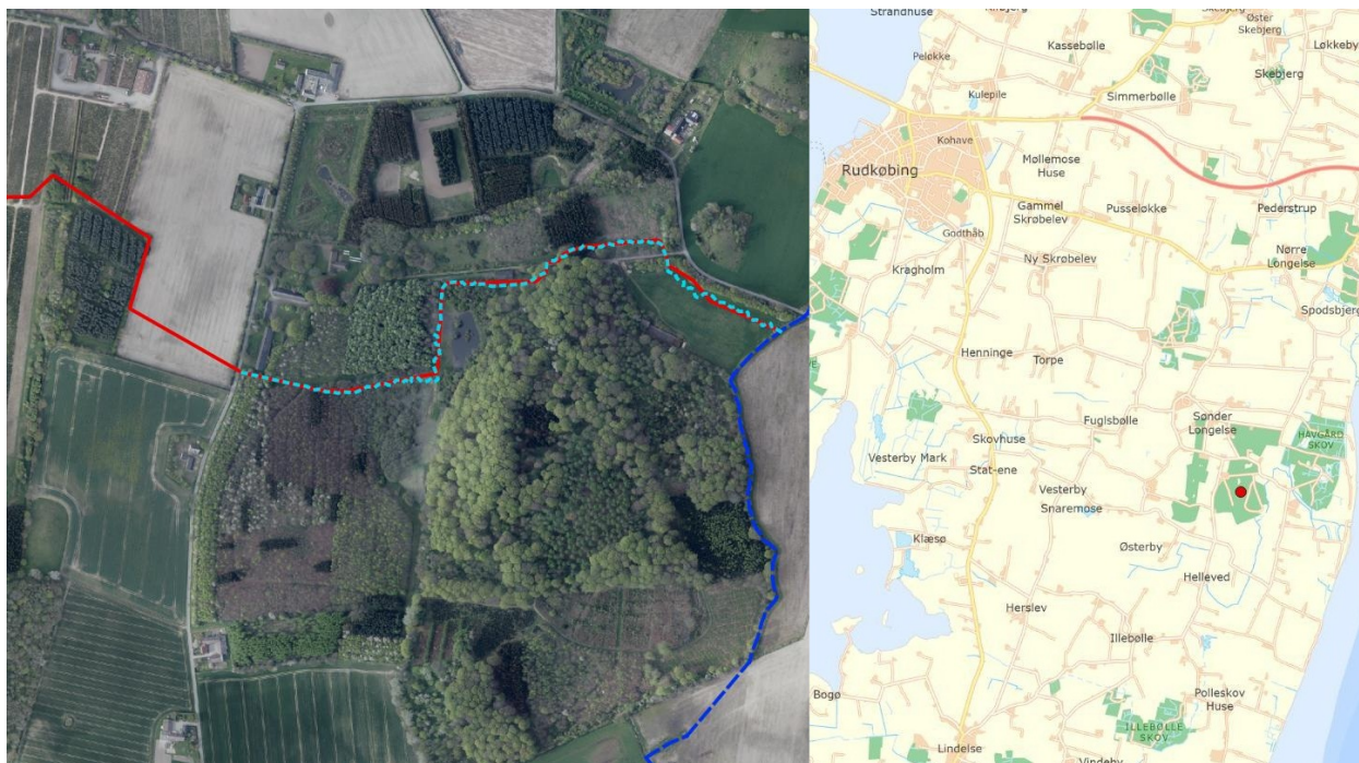
Figur 1: T.V. Nuværende rørlagte tracé markeret med rød linje, nyt åbnet tracé markeret med lyseblå stiplede linje, § 3 beskyttet vandløb, Fladmose-Helleved Afløbet, markeret med blå stiplede linje. T.H. Placering af projektet på Langeland markeret med rød prik. © Dataforsyningen
