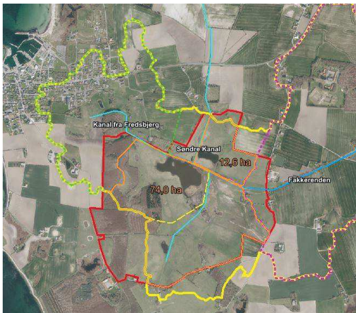
Figur 21 Opland til søerne med Projektforslag 2, (orange kurve). Kanalerne fra Fakkemose og Fredsbjerg ledes uændret gennem projektområdet, mens den sydlige strækning af Søndre Kanal tilfyldes.
